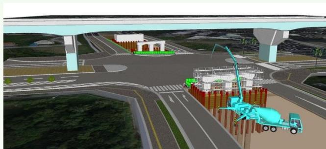
橋梁下部工工事の3Dモデル (埋設構造物は半透過表示)
