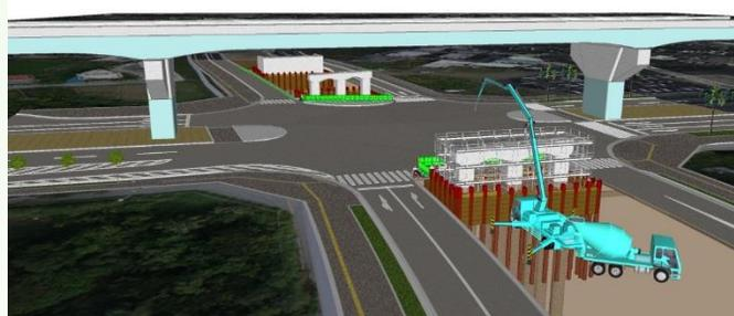
橋梁下部工工事の3Dモデル (埋設構造物は半透過表示)
