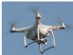
UAV(ドローン等)による3次元測量
